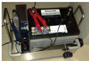
写真 2 充電器とバッテリーをパッケージにした試作品
