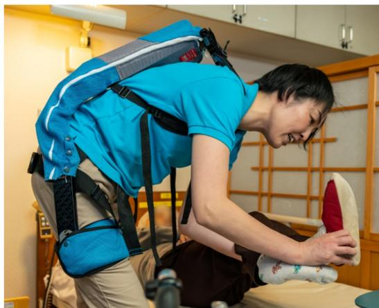
マッスルスーツは、かがんだりしゃがんだりする動作を、人工筋肉を使って反発力でサポートする支援機器です。「背中フレーム」と「ももフレーム」、その両者をつなぐ「回転軸」で構成されます。人工筋肉の上端を「背中フレーム」上部に固定し、下端に接続したワイヤを回転軸に固定します。人工筋肉の収縮によってワイヤが引っ張られて背中フレームが「回転軸」回りに回転し、回転軸に固定されたももフレームが反対方向に回転することで、ももを支点にして上半身を起こします\*3。以上より、介護者の腰部にかかる負担の軽減が期待できます(参考資料1)。
