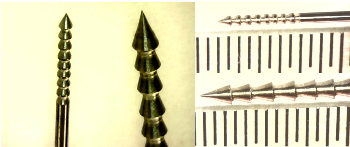
図.5 0.5mm径および1mm径の高硬度超合金の加工精度
