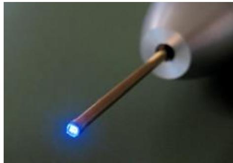
従来の方法に比較し紫外線の強力なスポット照射が可能となり、紫外線 LED を用いた歯科治療用機器が開発されれば極めて有効な口腔内治療機器となる。紫外線 LED は、口腔のみならず医療全般に応用範囲が広い世界最先端技術であり、まずは口腔分野で機器開発を進め、将来的には医療全般に広げる予定である。
