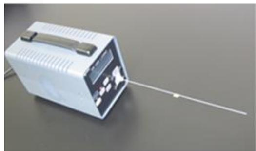
さらに、紫外線は通常のファイバーを透過できず、石英ファイバーのみを透過する。よって、口腔内への紫外線の照射は困難であり、ファイバーを使った胃カメラ、大腸ファイバーなどの医療機器に紫外線を用いることができなかった。歯科口腔先端診療開発部では、治療機器の先端に紫外線 LED を直接装備し、口腔内に直接紫外線を照射できる装置を開発した。
