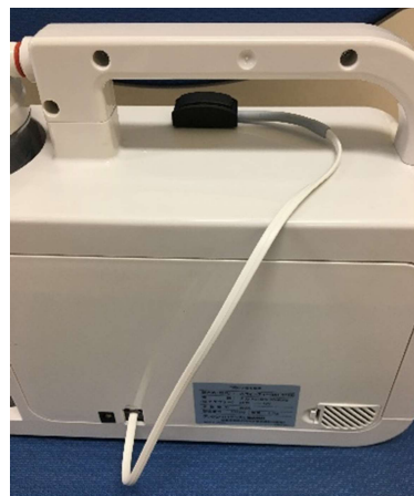
図6：スイッチを上部に取り付け
