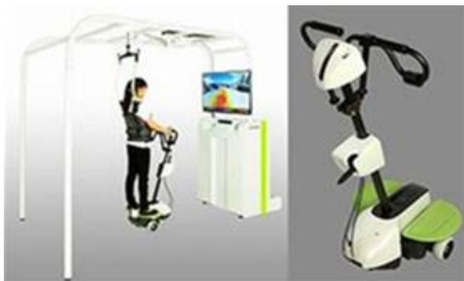
図1. バランス練習アシストロボット
