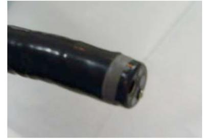
図1a. 従来の内視鏡 (外径9.2mm)
