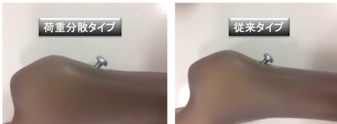
図9 模擬骨へ刺入した状態の写真
